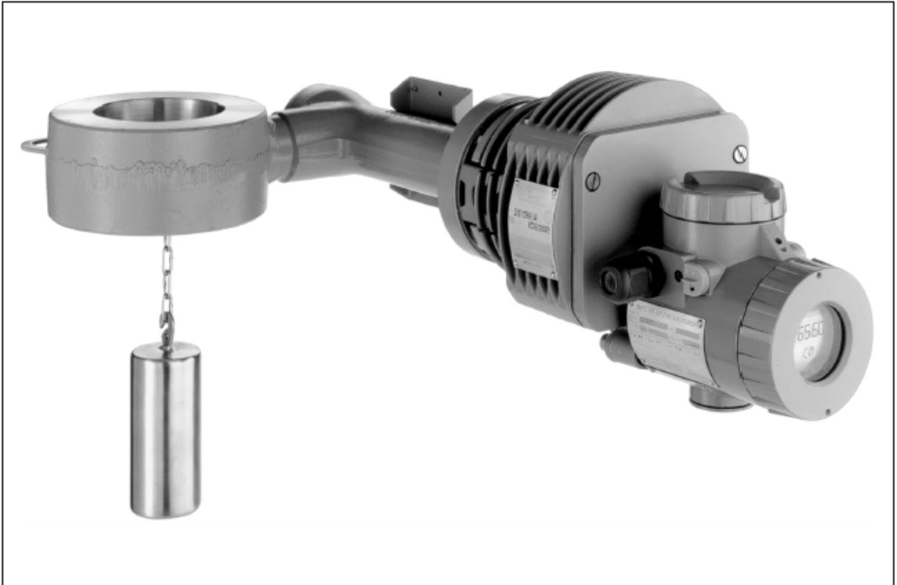
该变送器设计用于测量液位、界位或液体密度。测量基于阿基米德浮力原理。利用 PC 或通用手操器可以方便地进行远程组态和监控。利用现场按键，还可对仪表进行常规设定。所有的 I/A 系列测量都可通过 FOXC0M 通讯协议集成。变送器已通过认证可用于危险区域。
