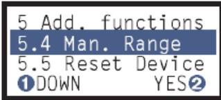
手动模式时按压按键 2 将进入量程设置, 量程下限值只有当罐内液位对应于 F<sub>0</sub> (液位浮筒悬空, 界位为完全浸没在轻介质中) 或工厂标定情况下悬挂 F<sub>0</sub> 对应的重量时才能设置; 量程上限值为液位、界位的满度或工厂标定时悬挂 F<sub>100</sub> 对应重量时才能设置。
