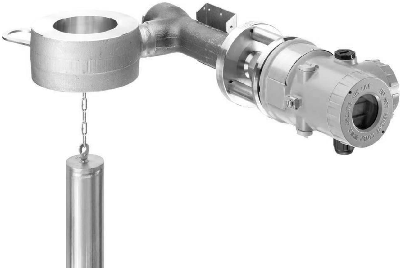
LC3144LD 液位之星智能型变送器设计用于连续测量所有的工业应用中的液体的液位、界面或密度。测量基于阿基米德浮力原理，因而产品极其坚固耐用。测量数值可以转换成模拟量和数字信号。通过 PC 或者控制系统，数字通信方便进行完整的操作和组态。即使在极高温，高压和强腐蚀性液体中，LC3144LD 始终可以稳定地、高精度地测量。它被批准可安装在爆炸性气体环境中。LC3144LD 结合了 FOXC 丰富的经验，采用了最先进的数字技术。
